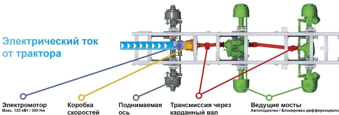
E-Drive JOSKIN - это гибридная технология, в основу которой были включены несколько ключевых элементов, главный из которых - мотор. Этот мотор производства SCHABMÜLLER трансформирует поступающую электрическую энергию в механическую мощность до 120 кВт при усилии 210 Нм (максимум 300 Нм). Коробка передач произведена компанией DINTEC.
